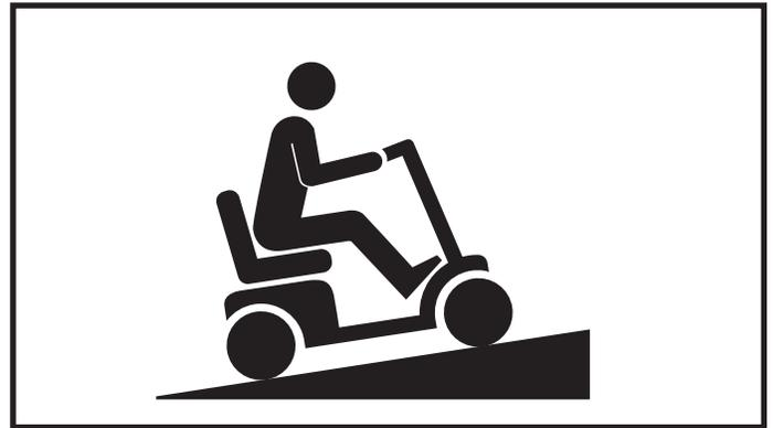
Figura 4. Posición de conducción de mayor estabilidad
